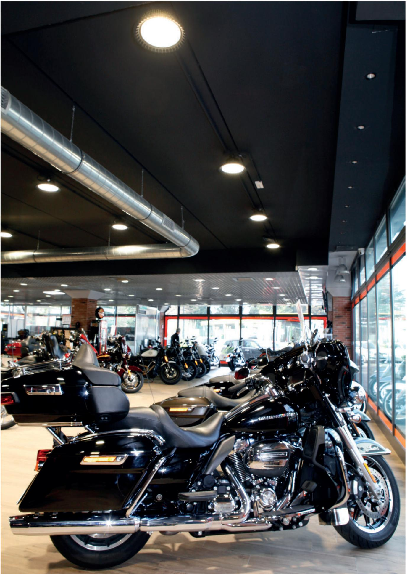
Il progetto dell'architetto Stefano Cellerino dello studio Modus di Milano, dopo un accurato studio relativo agli spazi e alle esigenze estetiche e illuminotecniche, si è focalizzato su INDO nella versione a soffitto. INDO, apparecchio LED 4000K con potenza di 120 Watt, ha la struttura in pressofusione di alluminio e il diffusore in policarbonato per garantire un'altissima resa luminosa, ideale per ampie superfici e con importanti altezze.
