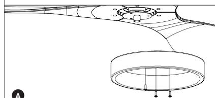
Svitare le viti. Installare il LED sulla parte inferiore del ventilatore inserendo le due viti nei fori corrispondenti. Ruotare l'unità e, in seguito, fissarla con le viti. È necessario allineare i fori per le viti a quelli nella parte inferiore del ventilatore. Infine, stringere le due viti per fissare il LED.
