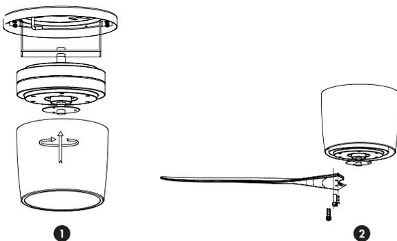
Allineare i fori delle pale a quelli del motore. Stringere le viti dopo aver disposto le pale. Prima di stringere le viti in maniera permanente, ripetere tale procedura con tutte le pale.
