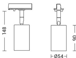
Il design unico, compatto ed essenziale di Manuka è stato studiato appositamente per unire estetica e funzionalità: con un semplice gesto il corpo in alluminio del proiettore arretra scoprendo la lampadina, permettendone una facile, veloce e sicura sostituzione.
